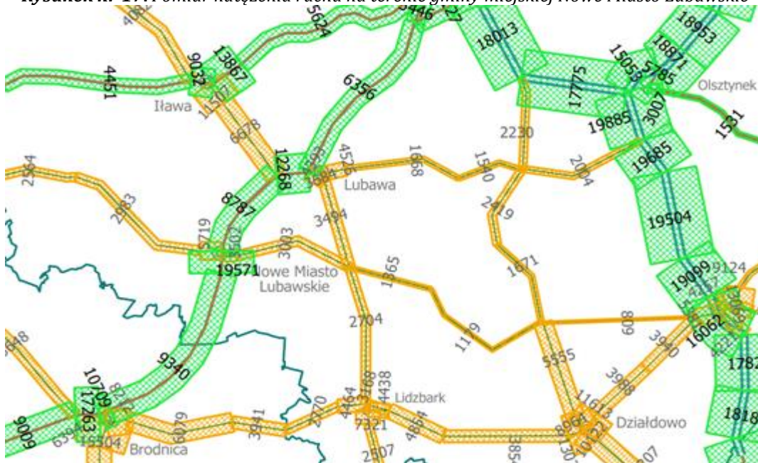
Rysunek nr 17. Pomiar natężenia ruchu na terenie gminy miejskiej Nowe Miasto Lubawskie
